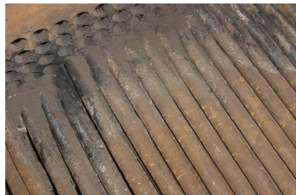
Fig. 1-a) Fouling Accumulation on the Tubes
